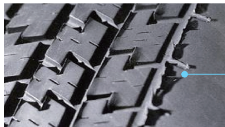
车轮定位不良造成的羽状边磨损。
