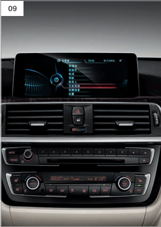
【08】M运动型多功能真皮方向盘，包括黑色Walkappa真皮方向盘外圈和仿形拇指靠。 【09】高级双区自动空调包括带活性炭过滤器的自动空气再循环(AAR)以及雾气和阳光传感器。
