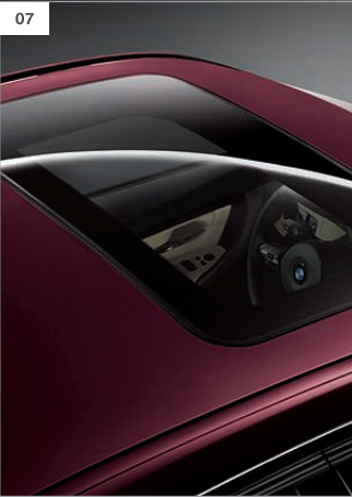
【07】玻璃天窗，带电动滑动和提升控制功能，使乘客可以根据个人喜好调节，同时确保无气流通风和更小风噪。
