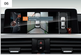
【04】全景摄像像是一种带俯视、侧视和后视摄像功能的视觉驻车辅助装置。
