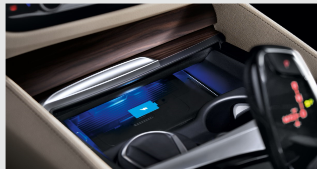
手机无线充电包括一个无线充电座和若干附加 USB 端口。可通过蓝牙同时连接两部移动电话和一台音频播放器。除此之外，还包括移动办公和 WiFi 热点。
