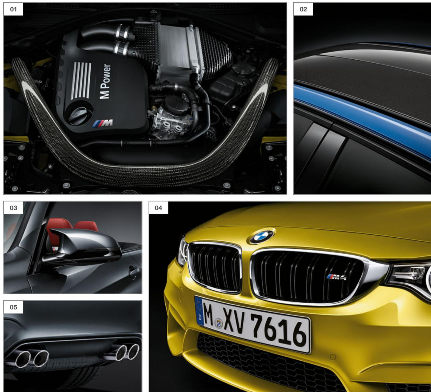
【01】碳纤维增强复合材料 (CFRP) 前端撑杆提高了前端刚度，从而提高了转向精度和准确性。【02】作为智能轻量化结构理念的一部分，碳纤维材质车顶<sup>1</sup>有助于降低车辆的重心。【03】按照空气动力学原理优化的 M 后视镜 (采用双桥设计) 和集成式 LED 指示灯，突出了汽车的动态特征。【04】带黑色高光双板条和型号标志的 M 双肾型进气格栅强调了前端的前推式设计。【05】两个成斜角的高光镀铬 M 双排气管与后裙板的流畅线条相得益彰。
