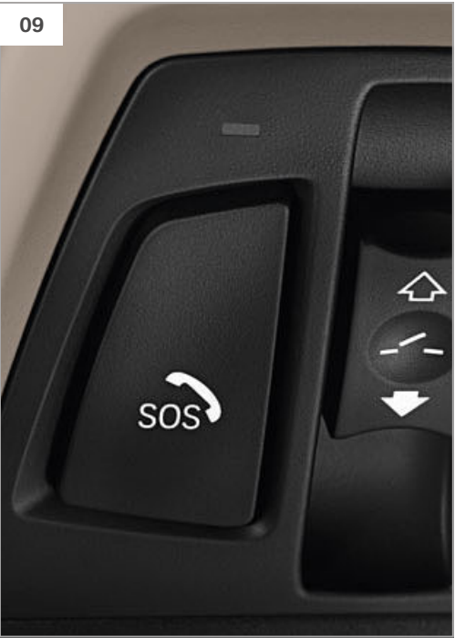
【09】智能紧急呼叫系统可在需要时通过 BMW 呼叫中心自动与最近的救援协调中心建立连接，而无需使用移动电话。
