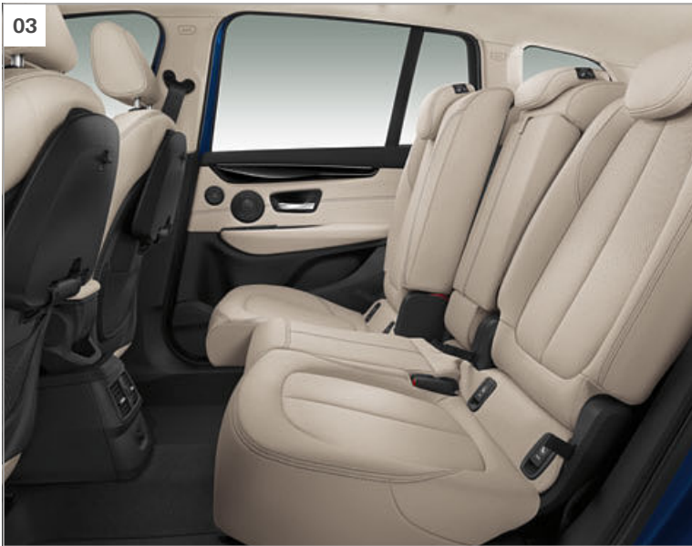
【03】后排长座椅由 3 个高质量座椅组成，可按照 60:40 的比例分开，并且可对前后位置进行调节。后排座椅靠背可按照 40:20:40 的比例折下，其角度也可进行调节，因此可提供更多的装载便捷性和令人难以置信的变化性。
