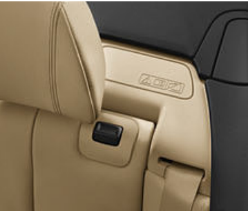
完全可伸缩的翻车保护系统 可提高车辆的被动安全性。如果出现翻车，自动打开的翻车防护杆以及增强的风挡玻璃框架可保护车辆乘员。
