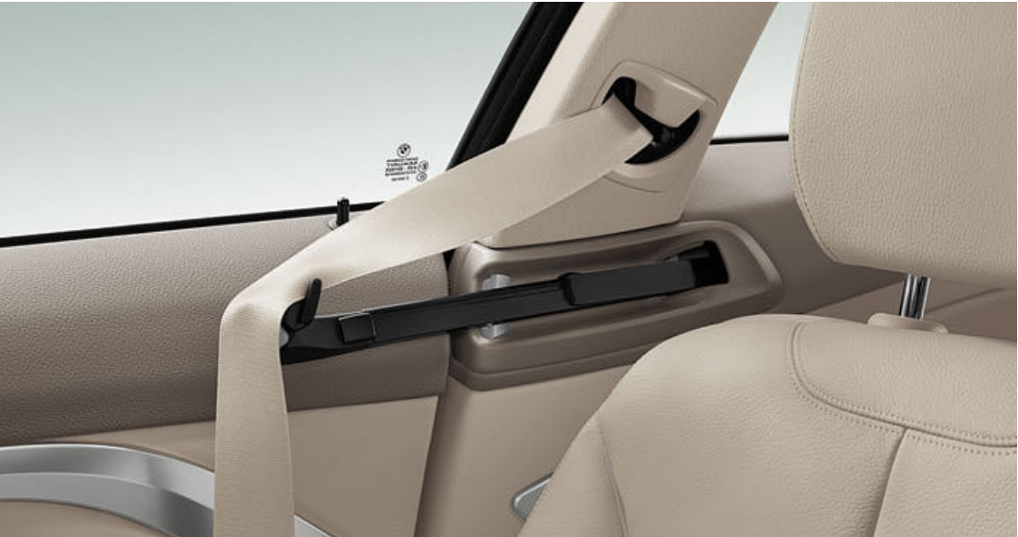
自动安全带插入器 可在钥匙位于点火位置且所有车门均关闭后将安全带从 B 柱移动至驾驶者和前座乘客触手可及的范围内。
