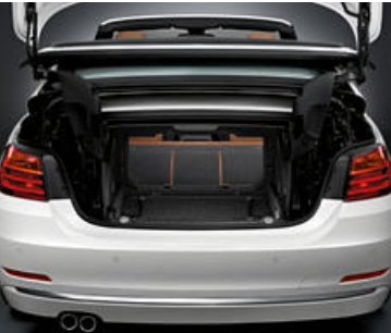
舒适装载功能。 此功能确保敞篷驾驶时能够更方便地使用行李箱。按下按钮，液压机构只需几秒钟时间便可将车顶组件 (包括行李箱盖) 向上移动，从而大大提高了整个行李箱的易用性。
