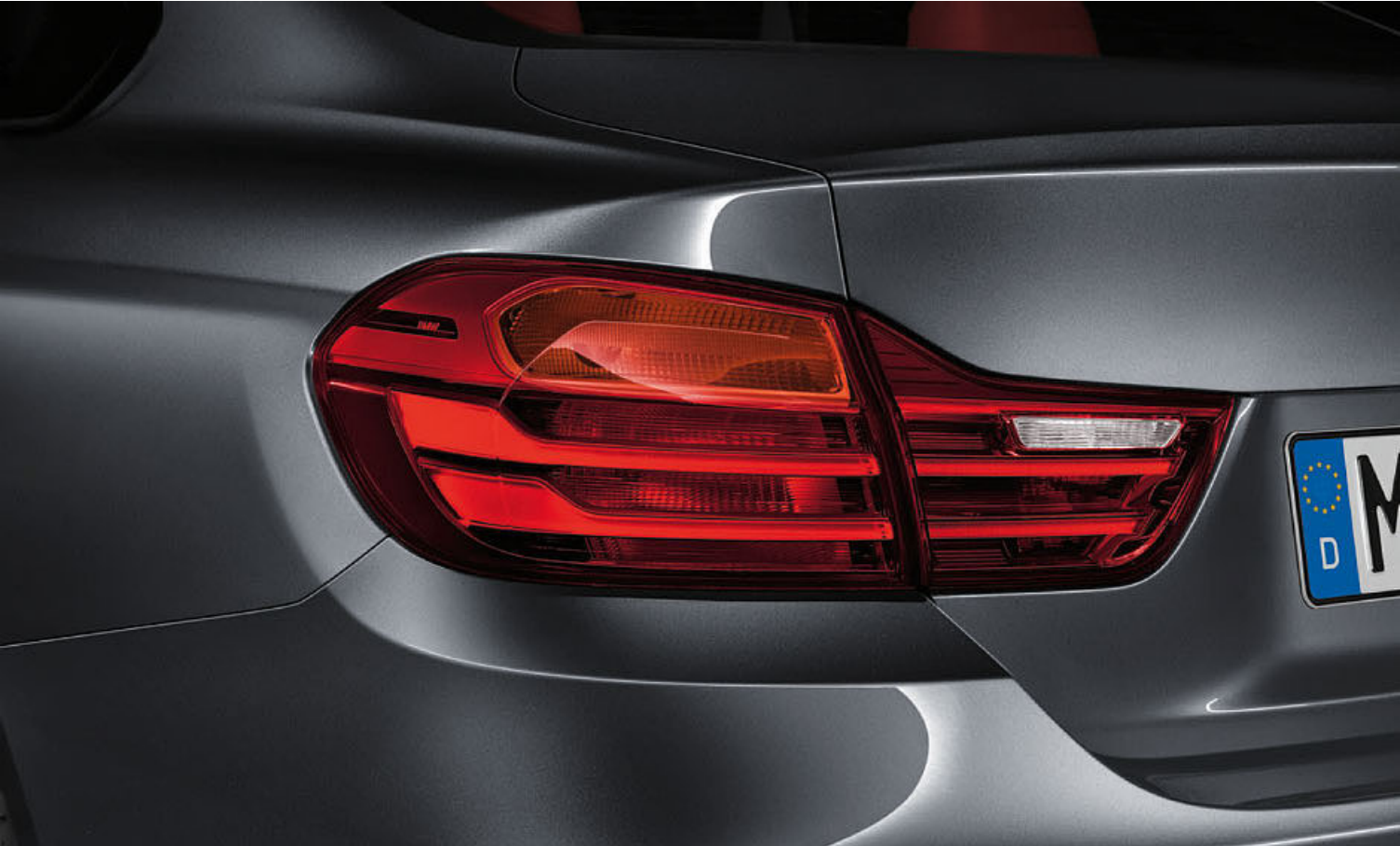
带闪烁功能的动态制动信号灯在紧急制动时自动启动，使尾随车辆的驾驶者能够分辨出您是轻踩制动踏板还是紧急制动，从而防止追尾。
