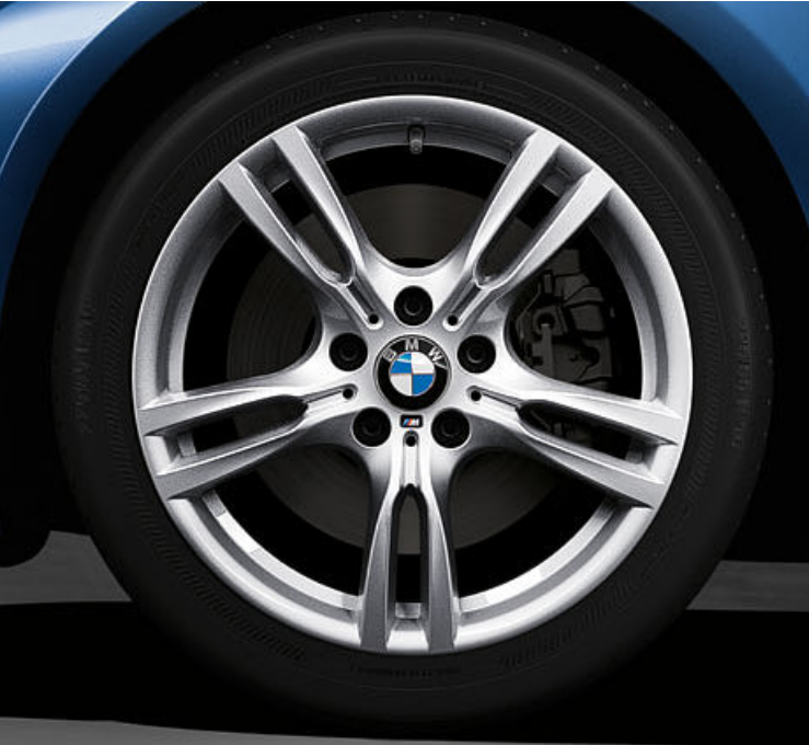
M 铝合金轮圈，星式轮辐 400 M 型，18 英寸，防爆轮胎，混装轮胎，前轮 8 J x 18 英寸，配 225/45 R 18 轮胎，后轮 8.5 J x 18 英寸，配 255/40 R 18 轮胎。
