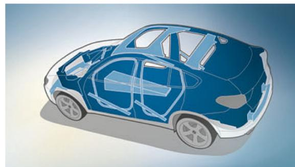
**乘客舱:** 功能性车身结构中采用的横梁和节点连接系统与高强度材料的整体布置相结合, 实现了发生正面碰撞、侧面碰撞或后向碰撞时的较大被动安全性。
