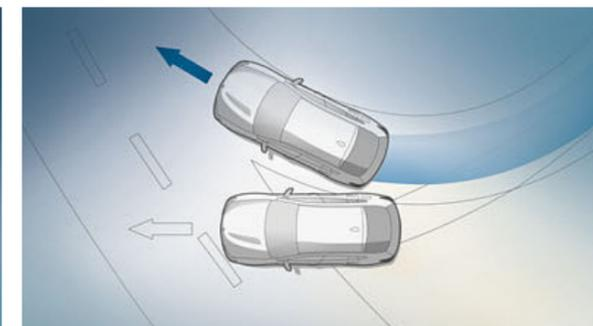
**动态稳定控制系统 (DSC)** 不断地评估车辆的运动并优化方向稳定性和牵引力控制, 必要时通过干预发动机和制动管理来实现。这可大大简化车辆操控 (即使在复杂路面上行驶, 也可从容不迫) 并有效提高了驾驶安全性。
