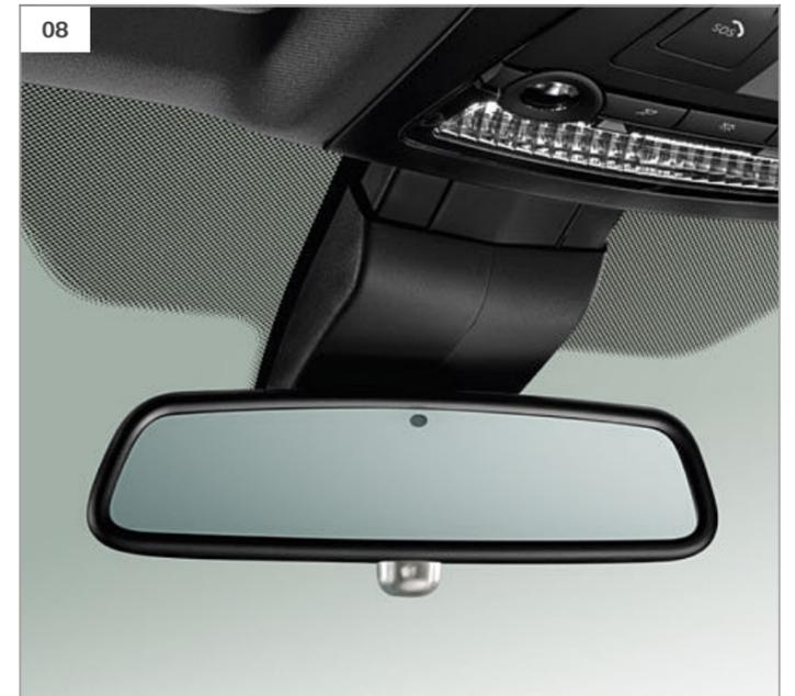
【06】BMW 商用级导航系统<sup>1</sup>, 带 iDrive 控制旋钮, 内置 6.5 英寸 LCD 彩色显示屏。系统可以每四年对地图进行免费更新。【07】BMW 专业级收音机配有 6.5 英寸彩色显示器、一键式 iDrive 控制按钮、CD 光盘驱动器和 MP3 解码器。【08】内部后视镜和驾驶员侧外部后视镜, 带自动防炫目功能及外后视镜折叠功能和前部乘员侧外后视镜自动停车功能。
