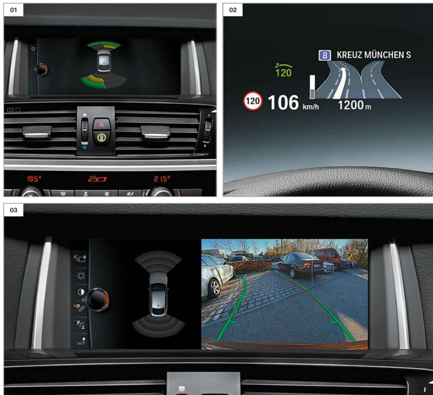
**【01】** 前后驻车距离报警器 (PDC) 通过发出声音警告信号以及在控制显示屏上给出指示, 令驻车 and 操纵方便许多。**【02】** 全景平视显示系统<sup>1</sup> 借助彩色高分辨率 TFT 显示屏直接将相关驾驶信息投影到驾驶员的视野内。可通知车速等信息并显示导航数据。使驾驶者将注意力始终集中在前方道路上, 驾驶就变得更加安全。**【03】** 后视摄像头可以将车后区域清楚地显示在控制显示屏上。
