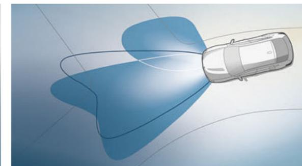
**随动控制大灯**采用市区和高速公路可变灯光分布技术, 包括防眩远光自动控制和转弯照明, 通过为前方道路提供出色照明, 可帮助提高驾驶安全性。每当驾驶者转动方向盘时, 移动的大灯光束便会照亮弯道和拐弯处。
