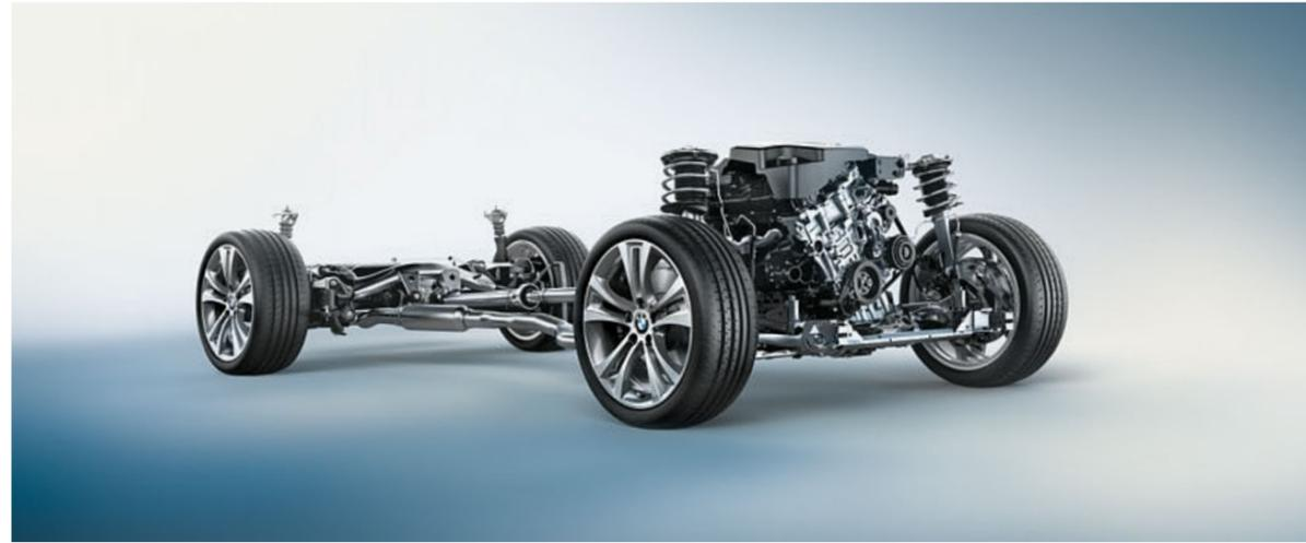
**xDrive 智能全轮驱动系统**可根据不同的路况自动进行调节，从而始终提供充足的牵引力轻松应对各种情况。xDrive 和动态稳定控制系统 (DSC) 可提供卓越的稳定性和操控性。xDrive 能够快速灵活地在车桥之间分配驱动力 (通过 DSC 传感器引导)，以防止过度转向或转向不足，从而确保出色的方向稳定性。因此，减少了动态稳定控制系统在艰难路况下的干预。xDrive 将全轮驱动系统在牵引力、方向稳定性和安全性方面的优势与 BMW 的灵活性结合在一起，带给您更大的驾驶乐趣。
