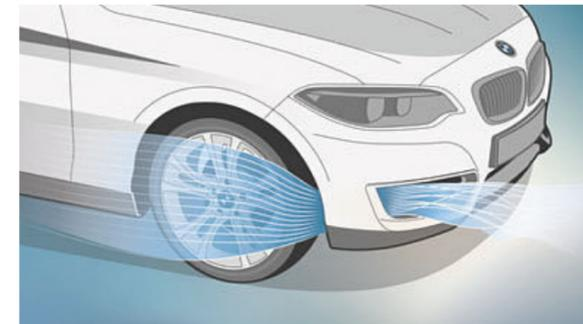
**空气幕**可引导前裙板和前轮的气流，从而减少空气扰动、空气阻力并降低油耗。
