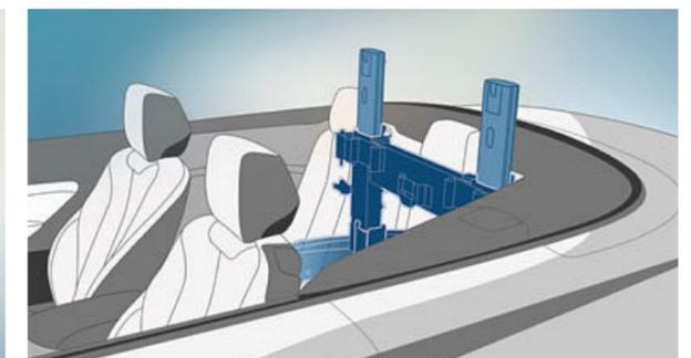
**全凹式翻车保护系统**具有可自动扩展的防倾杆，一旦车辆出现倾覆，便可保护敞篷轿跑车中的乘员。
