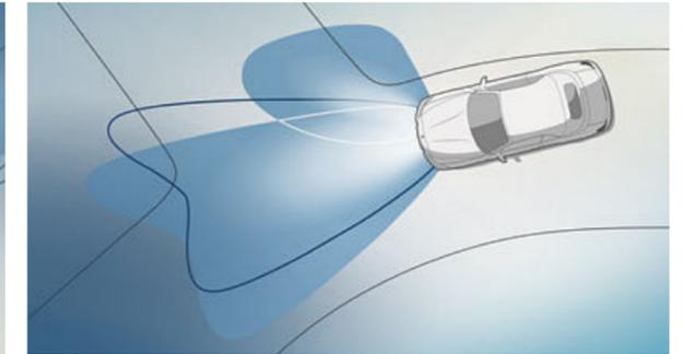
带可变灯光控制的**随动控制大灯**可在任何情况下提供出色照明，从而有助于提高主动安全性。
