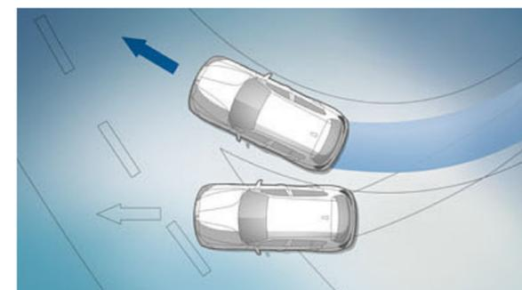
**动态稳定控制系统 (DSC)**可识别任何轮滑风险并稳定车辆。其扩展功能包括弯道制动控制 (CBC)、上坡启动辅助、制动辅助系统、制动器干燥功能和制动性能。
