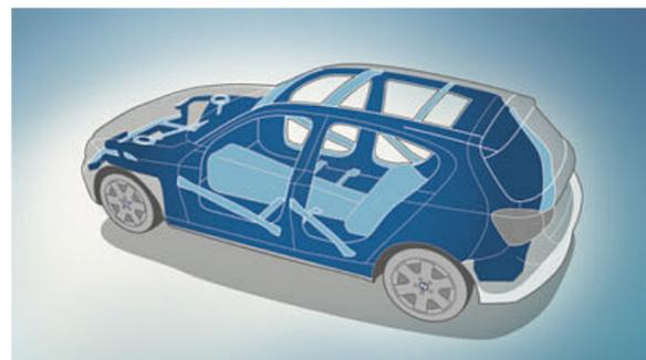
**乘客舱**的功能结构由一个包含纵梁和节点连接的专门的系统组成，并采用智能材料，可实现发生正面碰撞、侧向碰撞或向后碰撞时的更大被动安全性。
