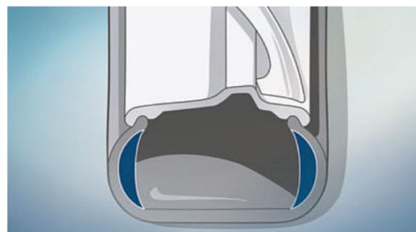
**防爆轮胎**采用加强型侧壁，可以防止轮胎在失压的情况下出现完全瘪胎或从轮圈上脱落，让您得以安全到达最近的维修处。
