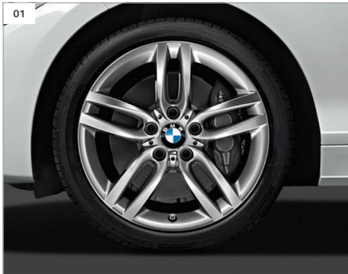
【01】M 铝合金轮圈, 双辐式样 461 M 型, 18 英寸, 铁灰色, 前轮 7.5 J x 18 英寸, 配 225/40 R 18 轮胎, 后轮 8 J x 18 英寸, 配 245/35 R 18 轮胎。
