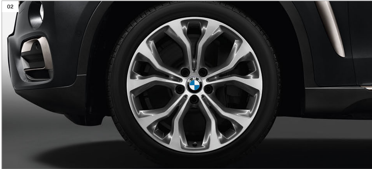
【01】 铝合金轮圈，Y式轮辐 595 型，19 英寸，防爆轮胎，9 J x 19 英寸，配 255/50 R 19 轮胎。
