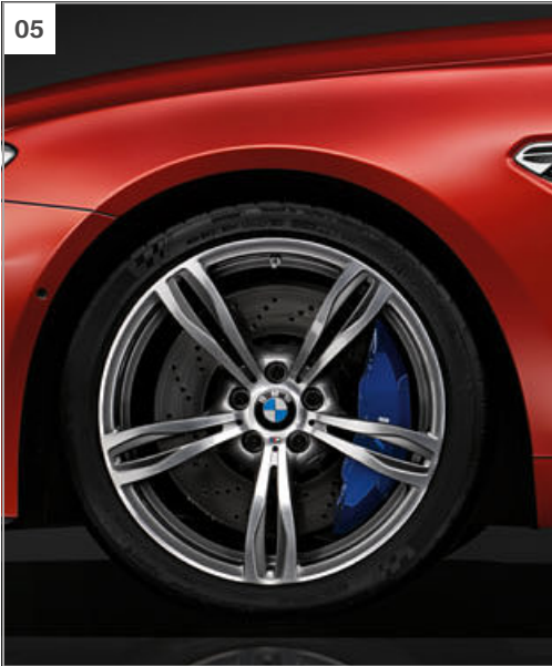
【05】M铝合金轮圈，双辐式样343 M型，20英寸，锻造，前轮9.5 J x 20英寸，配265/35 R 20轮胎；后轮10.5 J x 20英寸，配295/30 R 20轮胎。
