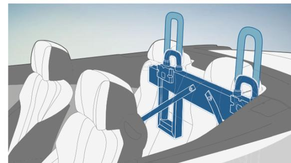
翻车保护系统<sup>1</sup>包括集成在风挡玻璃框架中的防倾杆以及隐蔽在后排头枕后方的防倾杆。当车辆即将要翻车时，一个弹簧加载机构会在瞬间将防倾杆推出。
