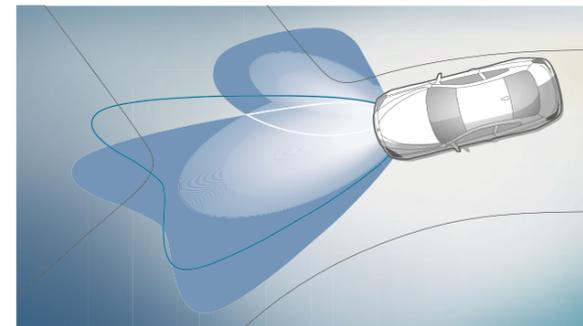
带可变城市和高速公路灯光分布的随动控制大灯，包括转弯照明(为前方道路提供出色照明)和带自动远近光的远光自动控制。
