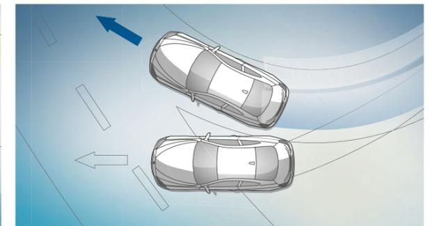
动态稳定控制系统 (DSC) 利用多个传感器持续追踪车辆状态，并在检测到不稳定驾驶条件时通过发动机和制动管理干预自动稳定车辆。
