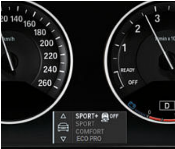
ECO PRO (节能) 模式的驾驶体验控制系统。只需按下中央控制台上的开关，便可选择您需要的模式。在COMFORT (舒适) 模式下，发动机和变速箱保持其标准设置。ECO PRO (节能) 模式以高效率为核心。SPORT (运动) 模式则侧重于实现更加动态的驾驶。当前启用的设置在车速表下方显示。
