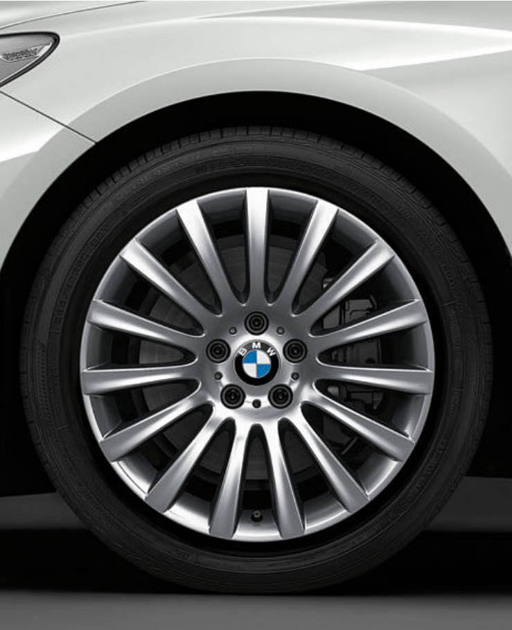
铝合金轮圈，多轮辐 235 型，19 英寸，混装轮胎，防爆轮胎，前轮 8.5 J x 19 英寸，配 245/45 R 19 轮胎，后轮 9.5 J x 19 英寸，配 275/40 R 19 轮胎。
