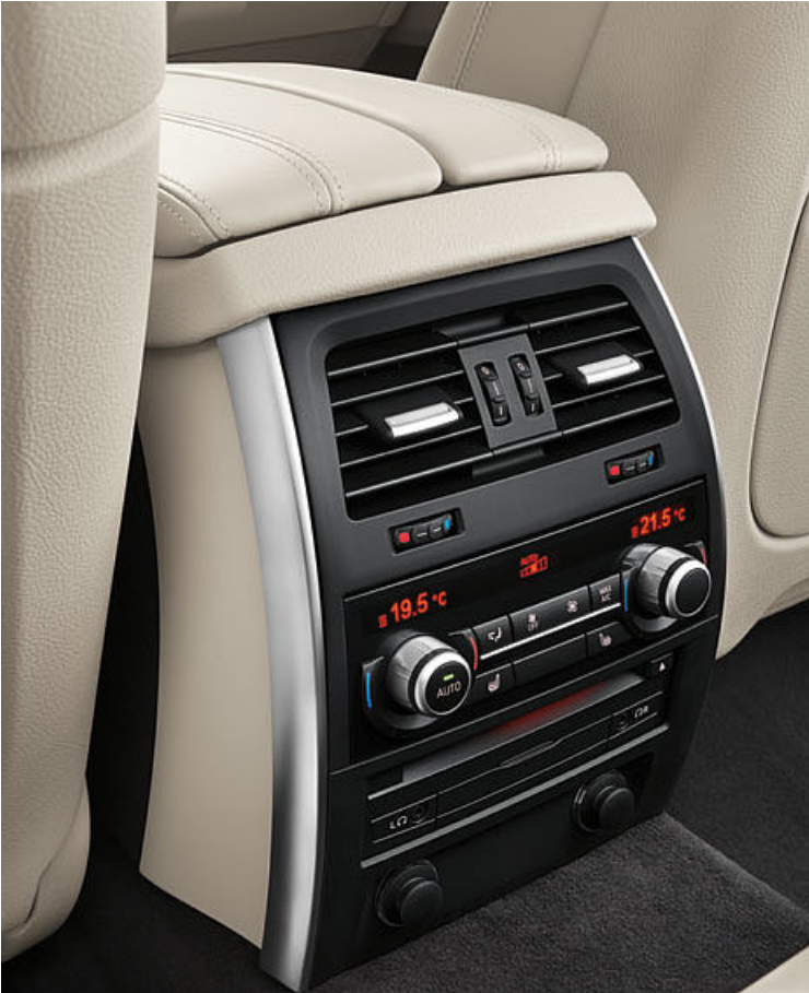
高级四区自动空调 ，除了双区自动空调的装备以外，还配备位于 B 柱中的多个附加通风口以及位于仪表板中心的一个舒适通风口，用于进行定向或无气流通风。此外，外侧后排座椅还配备单独的带显示的温度控制器。
