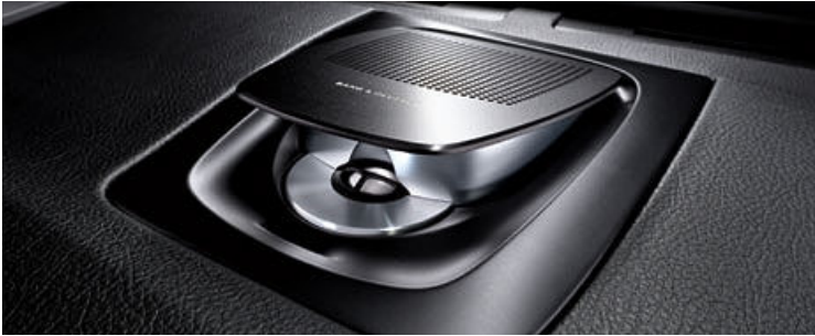
Bang & Olufsen 高端环绕音响系统 包括总功率为 1200 瓦的 16 个扬声器。Dirac Dimensions 数字信号处理系统还有助于确保出色的音质。该系统提供了 Studio (演播室) 和 Expanded (扩展) 两种声音选项，并可为单个扬声器固定框提供特殊照明效果。
