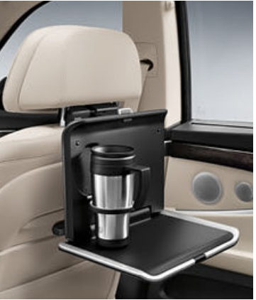
旅行和舒适性系统折叠桌 可为后座乘客提供一个实用的平面，其高度和倾斜度均可调节。
