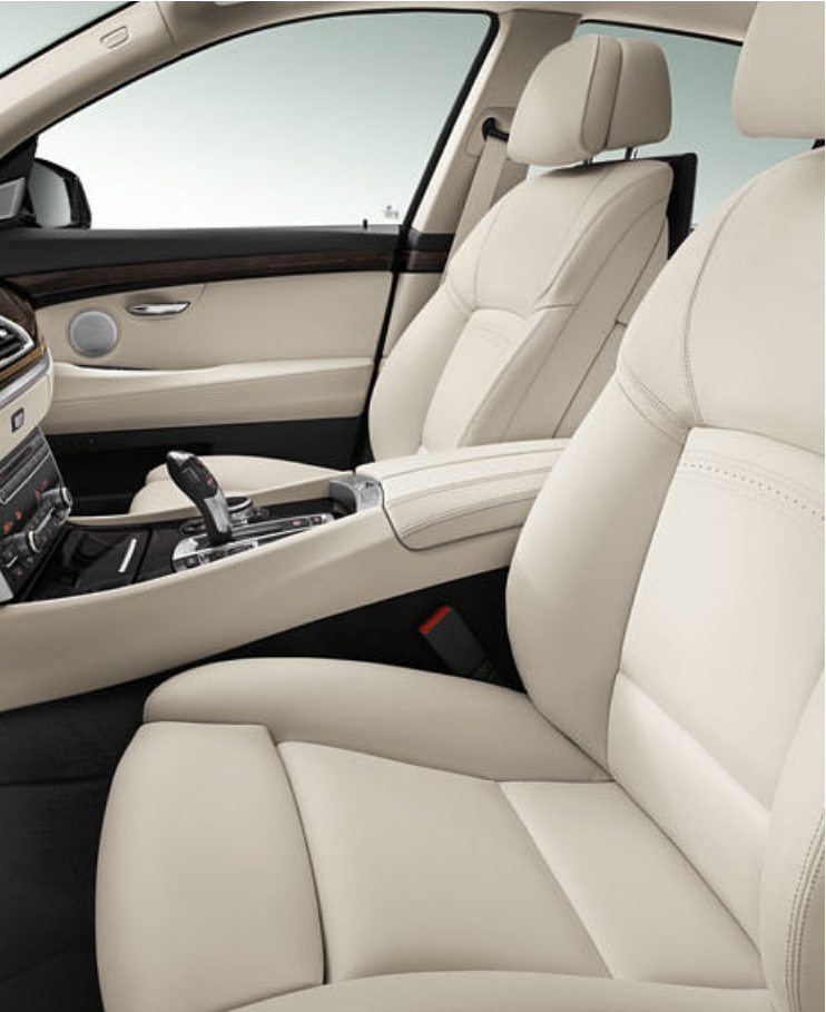
前排舒适型座椅，包括主动式头枕和多重电动调节功能。靠背上部、靠背宽度、大腿支撑和头枕高度均可单独进行配置。此外，还包括前排座椅电动腰撑和记忆功能。
