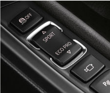
ECO PRO (节能) 模式的驾驶体验控制系统。只需按下中央控制台上的开关，便可选择您需要的模式。在COMFORT (舒适) 模式下，发动机和变速箱保持其标准设置。ECO PRO (节能) 模式以高效率为核心。SPORT (运动) 模式则侧重于实现更加动态的驾驶。当前启用的设置在车速表下方显示。
