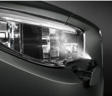
大灯清洗系统 可确保在所有天气条件下都提供出色照明。当风挡玻璃清洗功能启动时，大灯会与风挡玻璃同时自动进行清洁。
