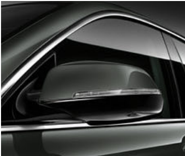
电动可调非球面后视镜 喷涂与车身颜色相同的车漆，并且集成了采用 LED 技术的转向指示灯。
