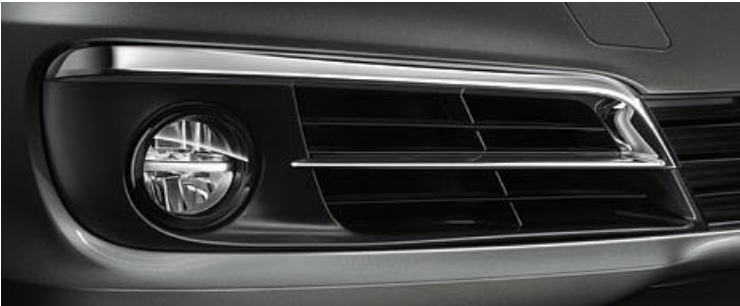
LED 雾灯 对 LED 或氙气前灯的颜色进行了和谐的补充。明亮的白光也可提高能见度较差时的安全性。
