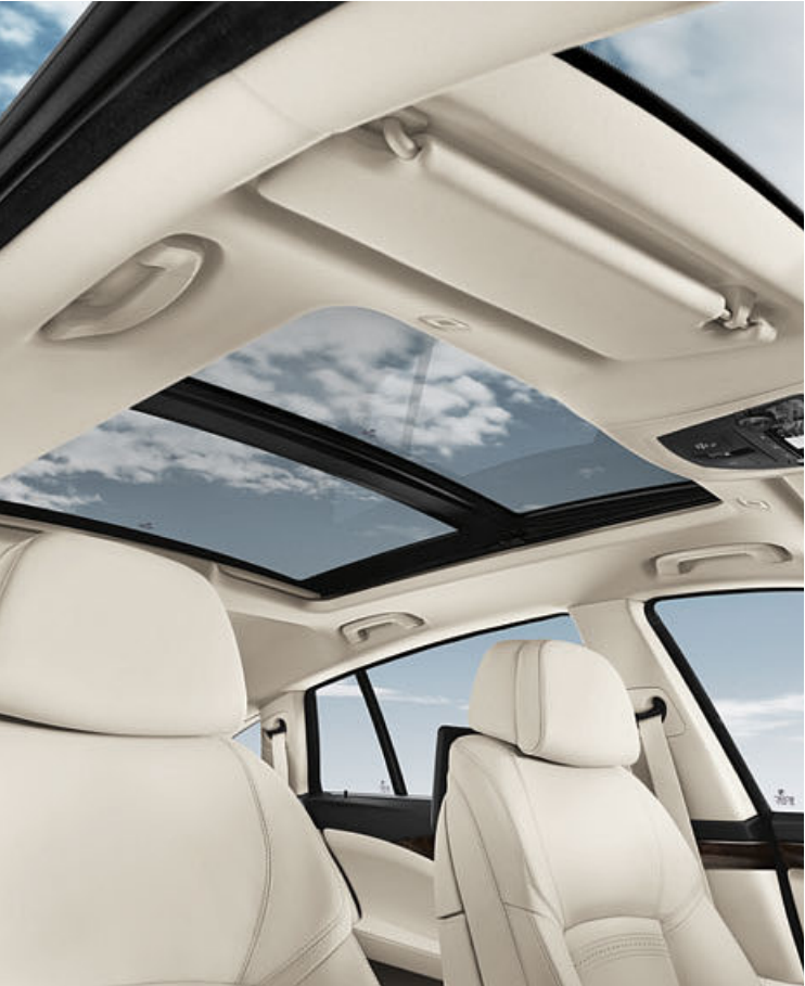
全景电动玻璃天窗 ，具有滑动和倾斜以及通过车钥匙舒适开启功能，带遮阳帘和挡风装置。
