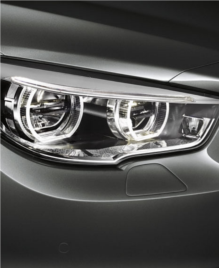
LED 随动控制大灯 ，带防眩远光自动控制、转弯照明和自适应照明灯。其明亮的颜色接近于日光，可为道路提供出色照明，从而改善了夜间驾驶时的能见度并减轻了疲劳程度。四个 LED 光冠圆环赋予车辆与众不同的外观。
