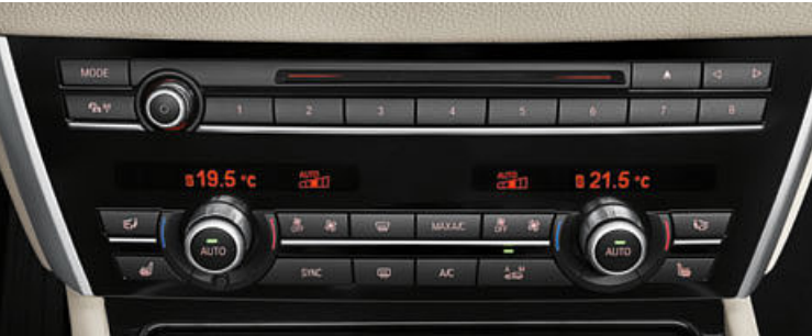
高级双区自动空调 以及自动气流和温度控制、驾驶者和前座乘客的单独设置。包括后排座椅通风口、微尘过滤器、雾气传感器、Max-Cool (最大制冷) 按钮和驻车通风功能。
