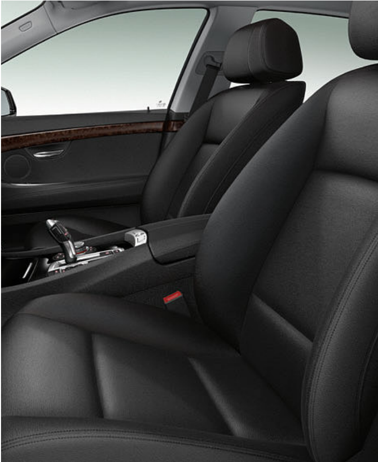
前排座椅具有座椅高度和靠背角度电动调节功能。驾驶者座椅的角度也电动可调。座椅前后位置和头枕高度手动可调。
