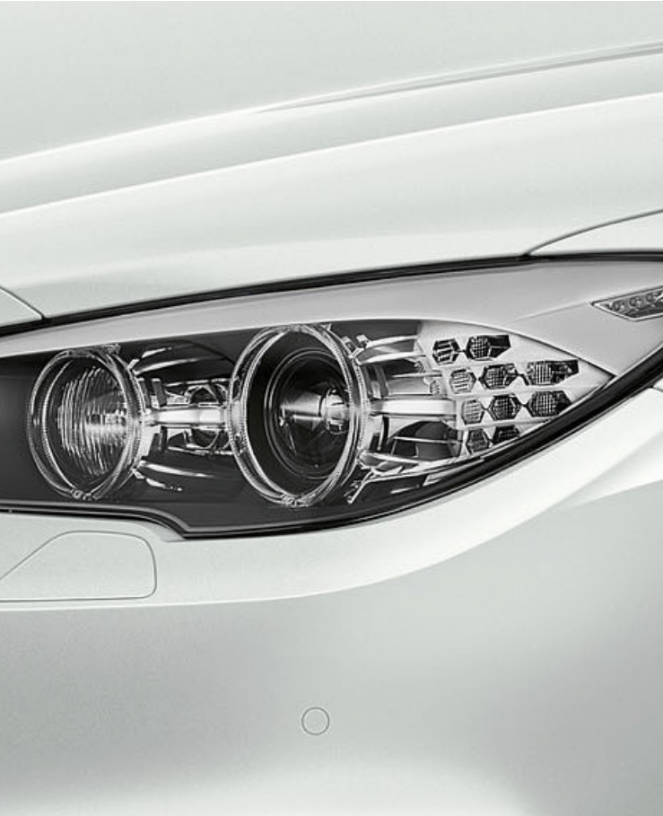
远近光氙气前灯 ，包括大灯清洗系统、采用 LED 技术的加强照明和侧指示灯、自动大灯光程控制系统，以及采用四个 LED 光冠圆环的驻车灯、停车灯和日间行车灯。
